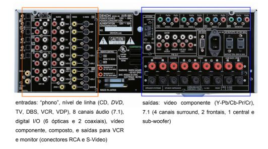
Figura 14 – Exemplo de painel traseiro de decodificador comercial (receiver)
