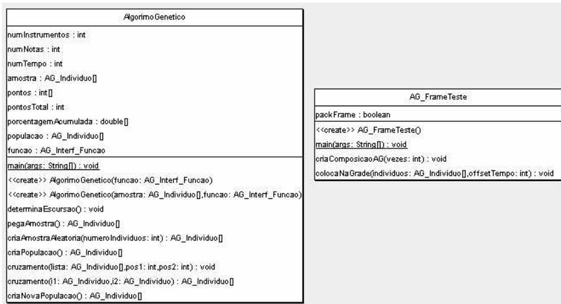
Figura 20: Diagrama das classes do AG – Classe principal e de execução.
