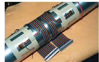
Corpo de prova (detalhe), mostrando os sensores (strain gages)
