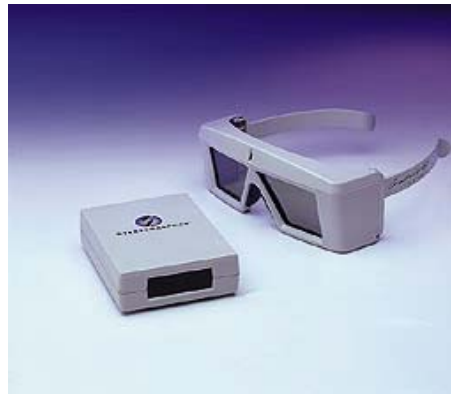
Figura 2-1 - Óculos Polarizador Estereoscópico Multiplexador de Imagens no Tempo
