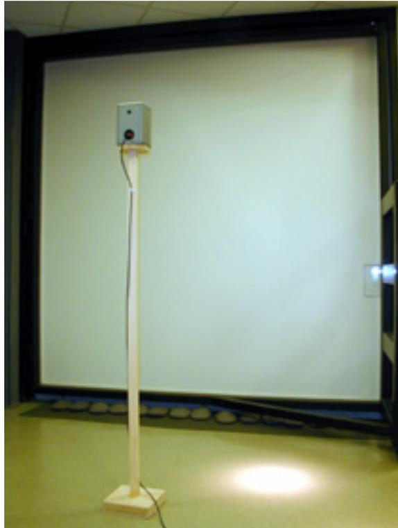
**Figura 43 – Pedestais de madeira reconfiguráveis para posicionamento dos alto-falantes**
