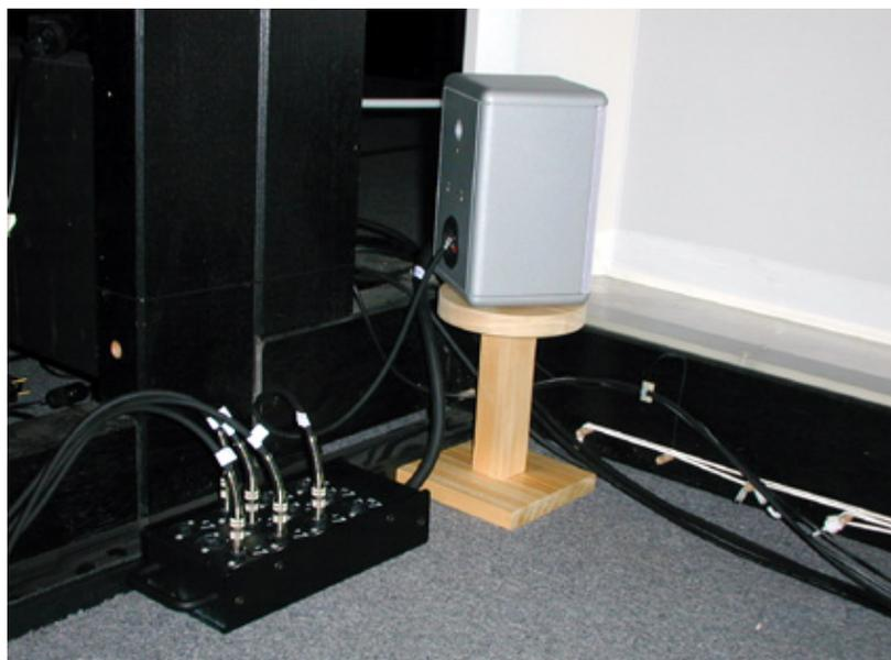
**Figura 41 – Foto ilustrativa da montagem e cabeamento de alto-falante nos cantos inferiores da CAVERNA.**
